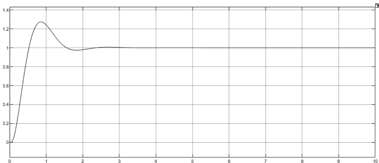
Рис.6 Характеристика ПИД-регулятора напряжения (заданное значение достигается на 3 с со следующими коэффициентами K=0.48 , Ki=0.47 , Kd=0.09 )
