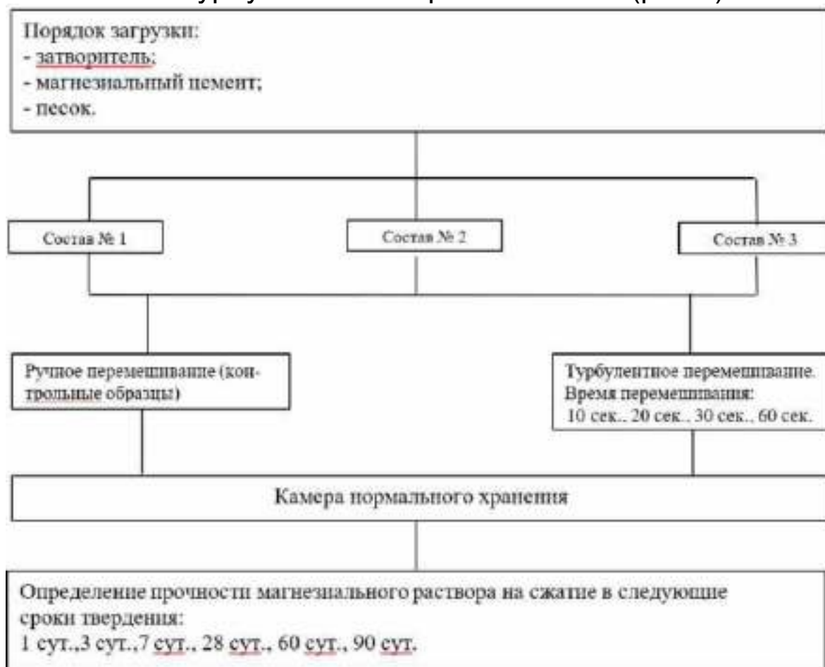
Рис.1. Методика проведения исследования по определению времени оптимального перемешивания магниезиального раствора в турбулентном смесителе.
