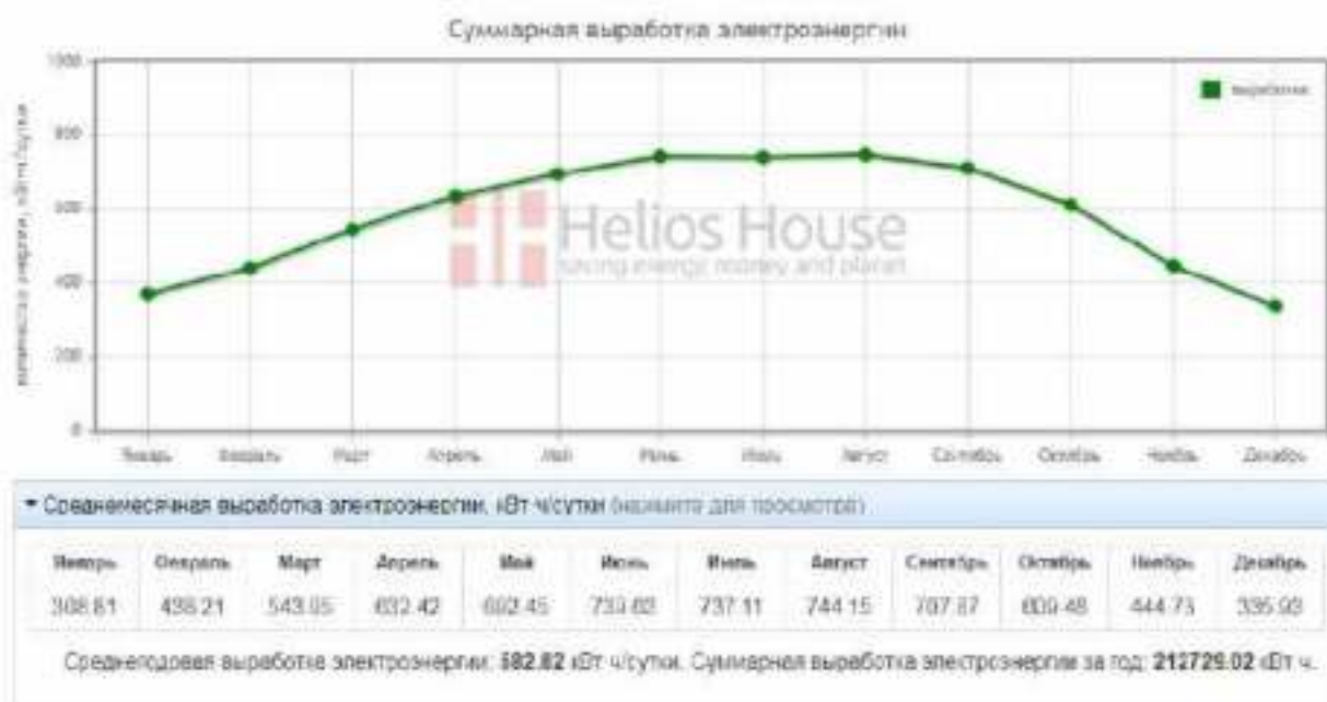
Рис. 4. Суммарная выработка электроэнергии ФЭС 100 кВт в г. Ташкент. Источник: helios-house.
